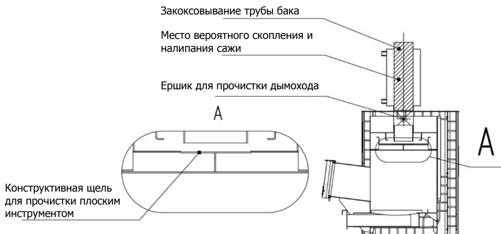
Рис. 5 Схема прочистки печи
