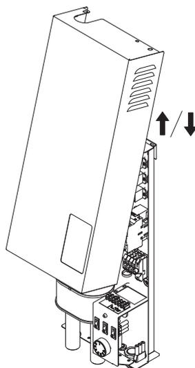
Рис.6 Демонтаж кожуха
